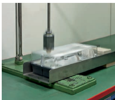
Bei Schlagprüfungen nach DIN EN 50102 wird mittels Feder- oder Fallhammer die maximale mechanische Beanspruchung von Materialien getestet.
